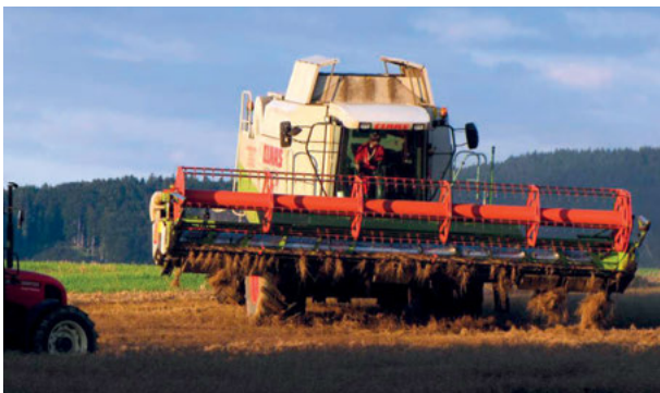
Obr. 3.: Manévrování sklízecí mlátičky CLAAS Lexion 460 před vyprázdněním zásobníku do přistavené traktorové soupravy.
